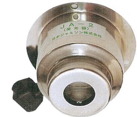
※受光器は天井に下向きに取り付けられます。投光器からの赤外線を受けますと、これを電気信号に変換して、ケーブルを通じて増幅器(アンプ)に出力します。
